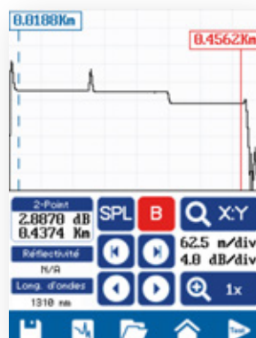
Trace OTDR affichée pour une analyse détaillée
